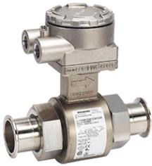
Das Messrohr 8721 in Hygienebauweise wurde speziell für Anwendungen im Bereich Lebensmittel, Getränke und Life Sciences konstruiert. Das robuste, vollverschweißte Messrohr mit vollem Durchgang besteht aus Werkstoffen mit FDA-Zulassung. Es darf das 3-A Symbol tragen (Genehmigung #1222) zugelassen. Die Nennweiten variieren von 15 mm bis 100 mm (½ Zoll bis 4 Zoll) und es ist mit einer Vielzahl unterschiedlicher Prozessanschlüsse nach Branchenstandard verfügbar.
