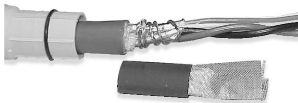
Afbeelding 3-5: Drain-draden afscherming tweemaal rond blootliggende folie gewikkeld
