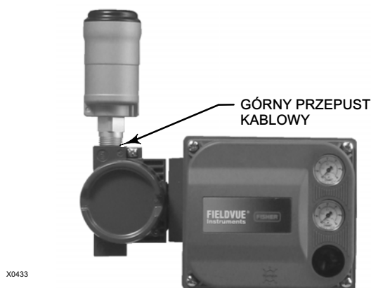
Ilustracja 26. Bezprzewodowy przekaźnik sygnałów THUM zainstalowany na cyfrowym sterowniku zaworu DVC6200
