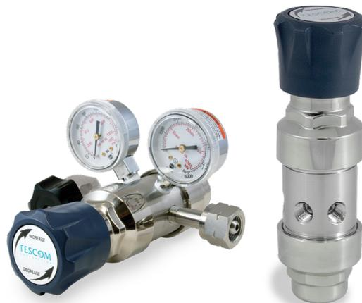
TESCOM SG2シリーズは、特殊媒体、可燃性ガスや工業用ガス向けのコンパクトかつ軽量な高純度2段階シリンダー型レギュレーターです。感度が高く、耐用年数の長いメタルダイヤフラムが、ガスの純度と完全性を保証します。モデル番号が分かりやすく分類されているため、仕様書作成者はレギュレーターアセンブリの一部としてオプションのゲージ、リリーフ/遮断バルブ、シリンダー接続を選択できます。
