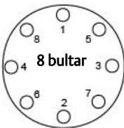
Figur 9. Åtdragningsmönster för flänsbultar
