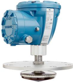
Das Rosemount 5900C Radar-Füllstandmessgerät bietet eine Messgenauigkeit von  $\pm 1$  mm (0,04 in.). Es wird gewöhnlich zusammen mit hochpräzisen Temperaturmessketten für Nettovolumenberechnungen eingesetzt. Es ist SIL-2-zertifiziert gemäß IEC 61508.
