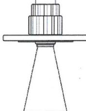
**Schema der Überfillsicherung**
